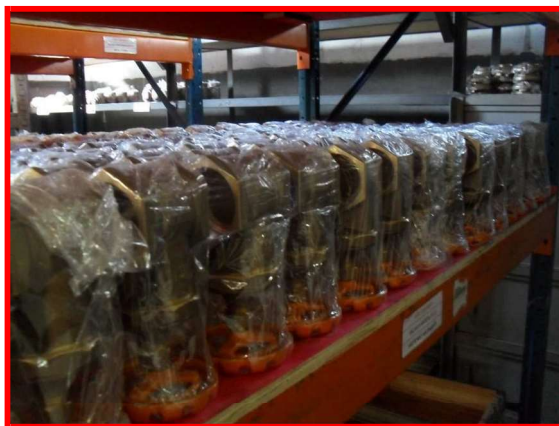
- Válvulas Alocadas sem Esforços Adicionais
