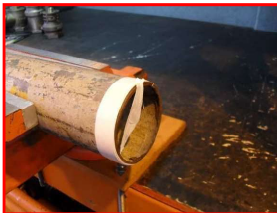
- Veda-Rosca Escoado para Dentro da Tubulação
