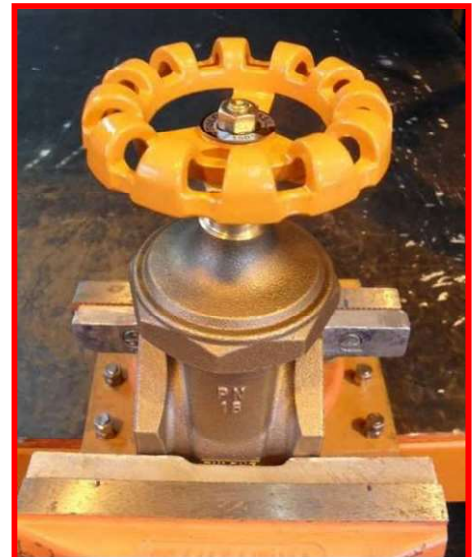
- Válvula Fixada Junto à Morsa
