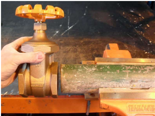
- Tubulação Fixada Junto à Morsa
